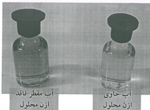
شکل ۴. نحوه تغییر رنگ آمپول (medium range 0.01 to 0.75 mg/L O 3 ) Ozone AccuVac® Ampuls در تماس با آب.
